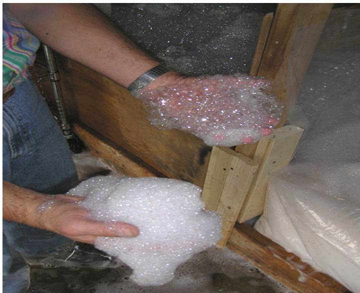
Снимка 5: Лява ръка пяна с по-голям обем, по-суха пяна; дясна ръка- пяна с по-малък обем на разширяване, по-мокра пяна
